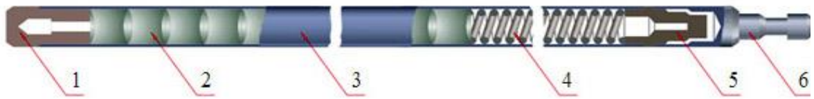
Рис. 26.6. Твэл реактора РБМК: 1 – заглушка, 2 – таблетки диоксида урана, 3 – оболочка из циркония, 4 – пружина, 5 – втулка, 6 – наконечник ( http://www.myshared.ru/slide/880701/ )
