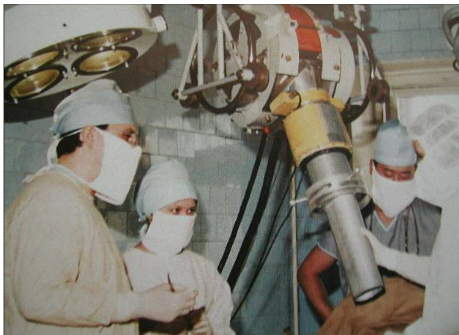
Рис. 1.7. Бетатрон МИБ-6Э с выведенным электронным пучком для интраоперационного облучения в операционной НИИ онкологии Томского национального исследовательского центра РАН г. Томск
