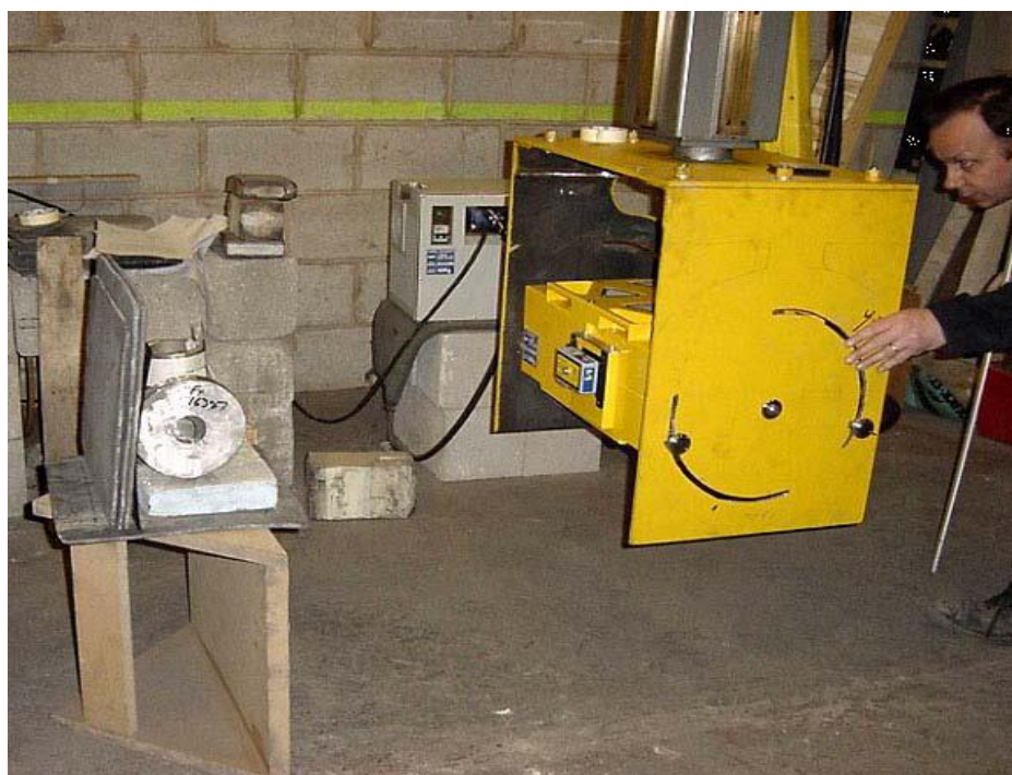
Рис. 1.3. Малогабаритный бетатрон ИНК ТПУ используется на промышленном предприятии в Великобритании при контроле литых изделий с толщиной по стали до 300 мм
