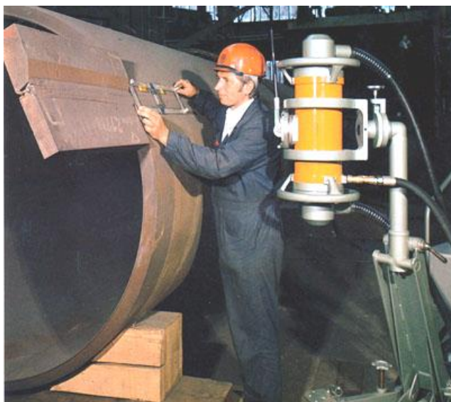
Рис. 1.1. Контроль сварных соединений труб с помощью рентгеновского излучения
