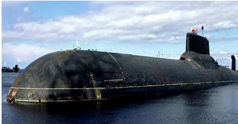
Рис. 1.9. Тяжелый подводный крейсер «Дмитрий Донской». Движение ракетносца обеспечивают два реактора мощностью по 360 МВт каждый
