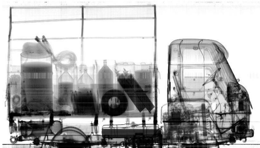
Рис. 1.2. Изображение, полученное на макете досмотровой системы, созданной в ИНК ТПУ на основе тормозного излучения
