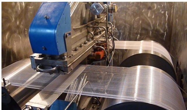
Рис. 20.3. Обработка кабельной продукции на ускорителе ИЛУ-8 ИЯФ СО РАН повышает прочность изделий и увеличивает производительность в 100 раз
